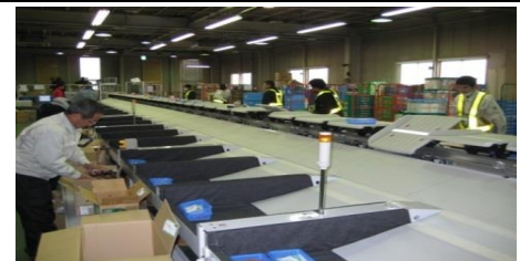
大宮センターのソーター(自動仕分機)による返品処理業務
