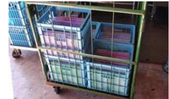
宅配から戻ったドライバーが使用済みの蓄冷剤を水色のケースに移し替えて籠車に収納します。
